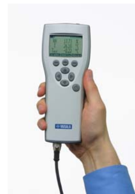
维萨拉公司 DRYCAP® 手持式露点仪 DM70 用于 DMT340 系列的户外校验。
