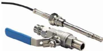
MMT338 探头安装在压力管线中，探头在流程工作时不需停机就可以拔出，探头深度可调节。
